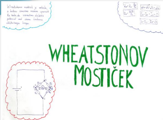
Slika 12: Mostično vezje in primer uporabe uporovnega lističa v senzoriki. Izdelek dijakov.
