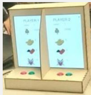
Slika 2: Implementacija elektronske igre zapornikova dilema s pomočjo računalnika Raspberry Pi.
